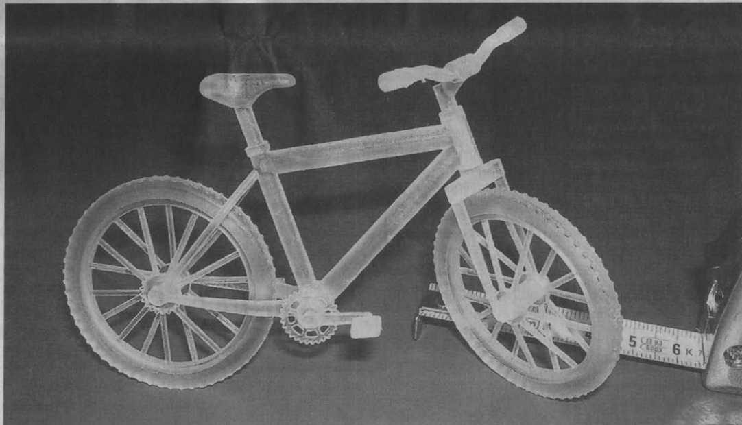
La précision de fabrication permet l'articulation des éléments: les roues et le guidon tournent!
