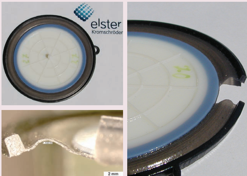
Die von der Elster GmbH mit nur 0,2 mm Wandstärke gedruckte Membrane für Gaszähler zeigte in einer Kraftkurve bessere Werte als das Original. Das Funktionsmodell bestand einen späteren Dauertest mit 25.000 Schaltungen ohne Probleme. (Bilder: Elster Kromschroder)
